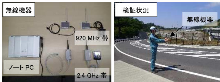
写真-1 現場検証用無線機器と検証状況
