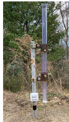
図-3 傾斜計の模式図と設置状況
