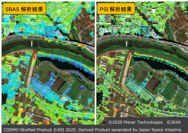
図1 SBAS法とPSI法の解析結果
