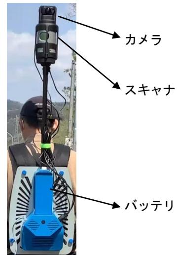
図-2.1 携帯型レーザ計測システムの外観
