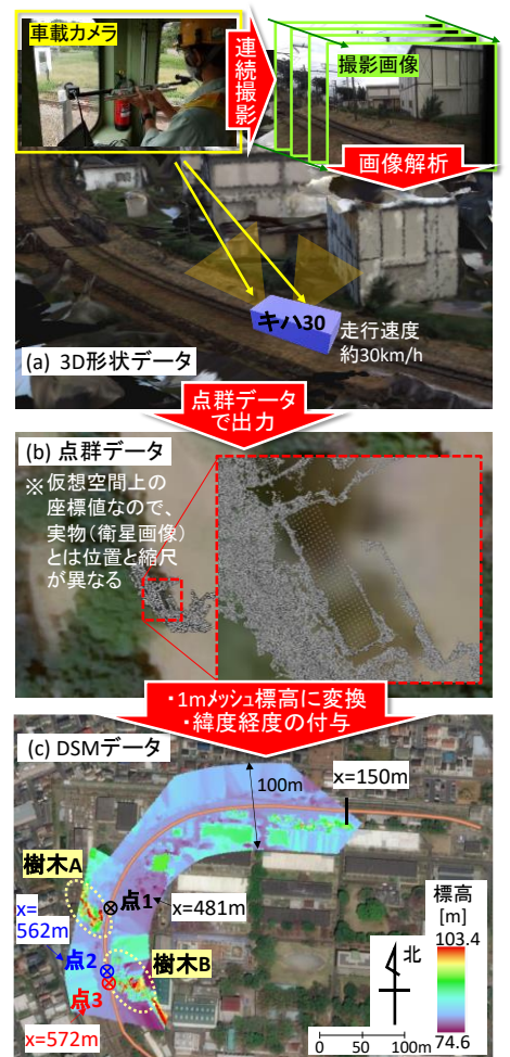
図2 車載カメラによる沿線樹木の3D形状測定とDSMデータ変換
