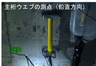
(b) 静ひずみ計の設置状況等
