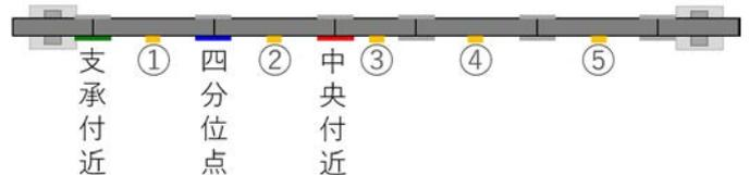
図4 センサ（黄色）と損傷位置（上面図）
