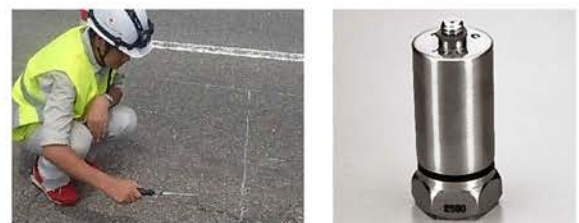
Fig. 2 弾性波励起状況(左)とセンサ(右)
