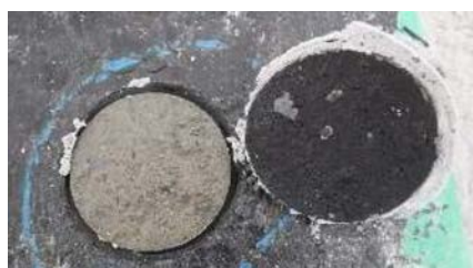
写真-5 ケース⑤破壊面
