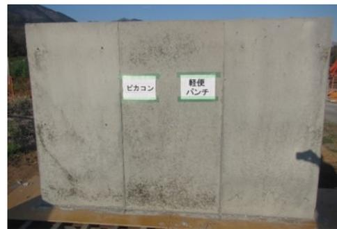
写真-3 打設実験脱型後写真
