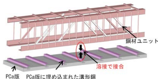
図-2 溝形鋼による接合方法
