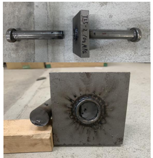
写真-3 溶接部破断の例
