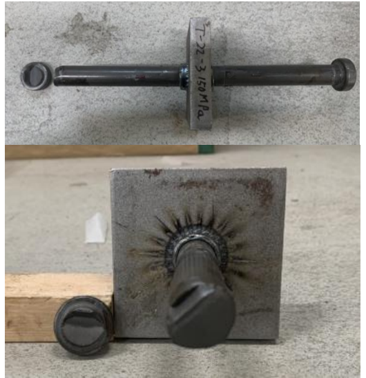
写真-2 頭部破断の例
