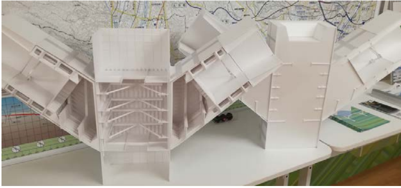
写真-2 スプリング鋼殻部のスケールモデル (向かって左側：内部構造可視可, 右側：コンクリート充填後)
