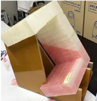
写真-3 3Dプリンタモデル (高流動コンクリート打設時の検討)
