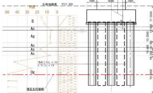
図-2 対象の橋脚構造図と土質条件
