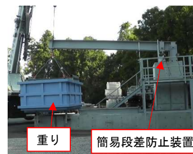
図-4 クリープ試験状況
