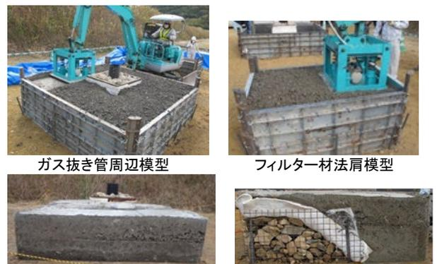
図-6 固化式処分の振動締固め状況と出来形
