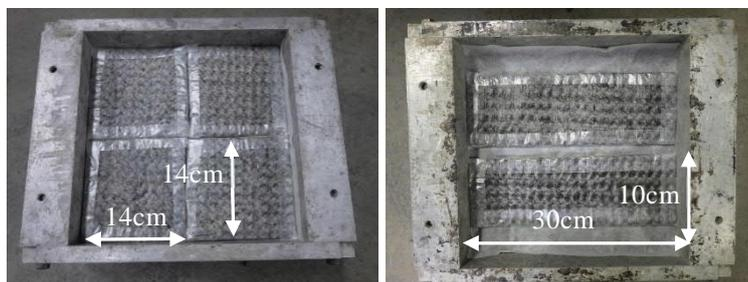
写真-2.1 自己修復マット敷設(付着、曲げ試験)
