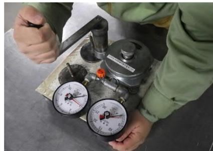
写真-3.1 付着力試験状況
