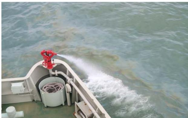
写真-2 放水銃による流出油の拡散
