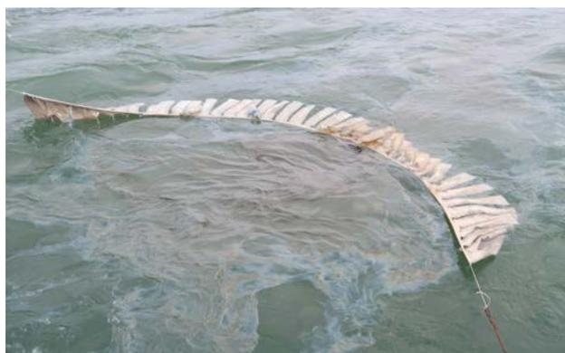
写真-3 油吸着マット(万国旗式)による油回収
