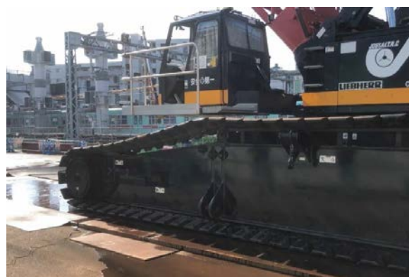
図-2 敷鉄板上をクローラークレーンが走行した時の様子
