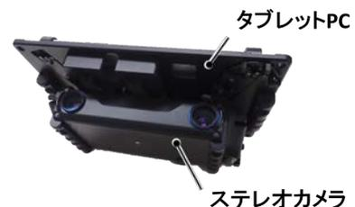
図-3 自動配筋検査システムの構成
