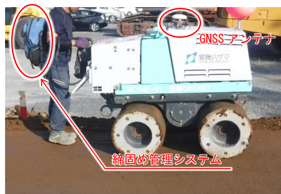
写真-1 小型振動ローラへのシステム搭載
