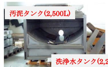
写真-5 汚泥、洗浄水タンク
