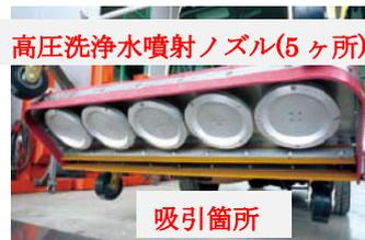
写真-4 高圧洗浄水噴射、吸引箇所
