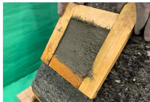
写真-1 敷モルタルの敷設試験状況
