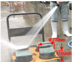
写真-1 打継面処理の状況
