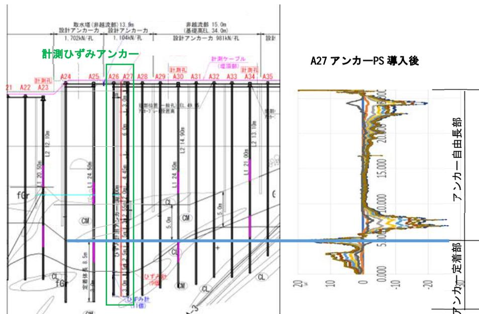
図-2 PS アンカーA27 導入時の堤体内ひずみ分布
