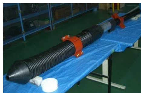
写真 3-1 テンドンの試作例 (定着長部)
