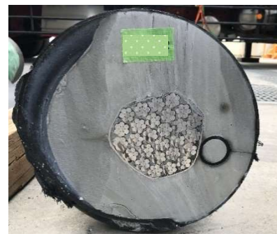
写真 4-3 充填後の断面
