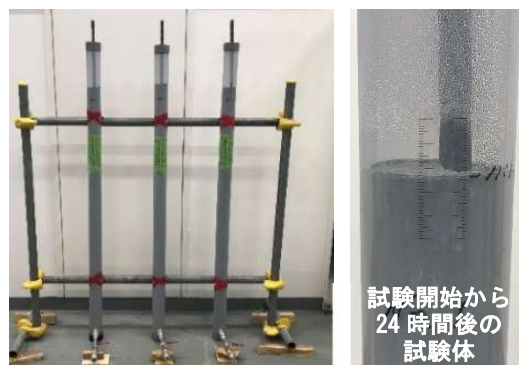
写真 4-1 体積変化率の試験状況
