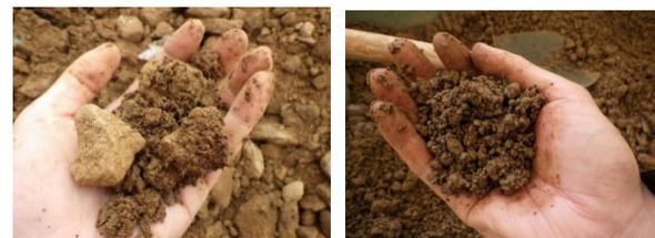
写真-3 母材(左)とコア調整材(右)
