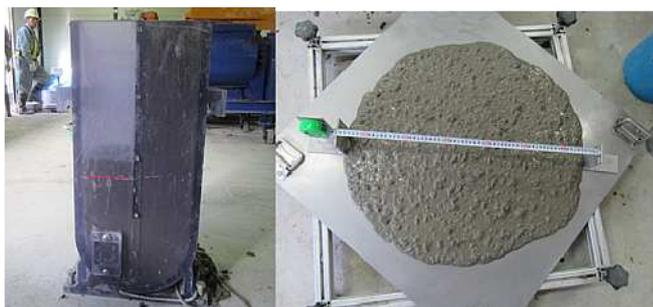
図-7 高流動コンクリート試験練り
