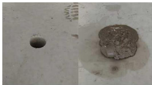
図-8 高流動コンクリート充填状況
