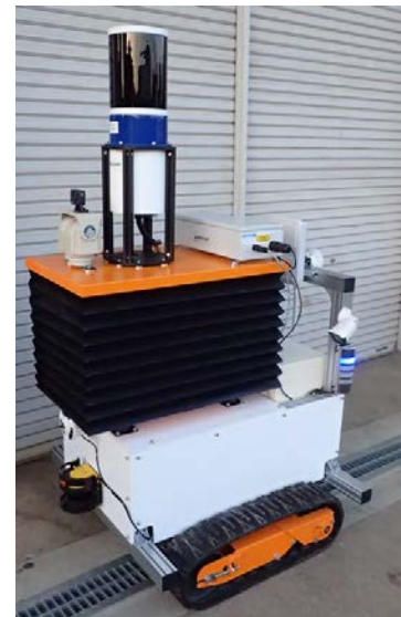
図-3 昇降リフト使用時の様子
