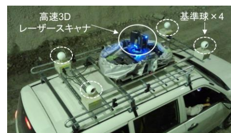
図-6 車載式トンネル 3D スキャニングシステムを用いた内空変位計測
