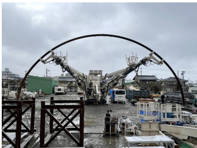
写真1 完全自動鋼製支保工建込みロボットの全景
