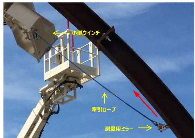
写真7. 小型ウインチ工場試験近景
