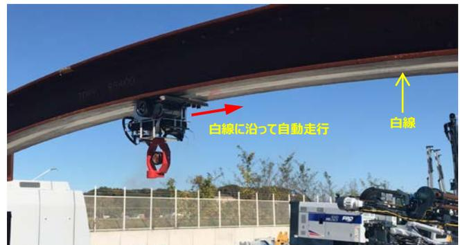
写真3. 小型ロボット工場試験状況
