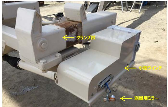
写真5. 小型ウインチ取付け状況
