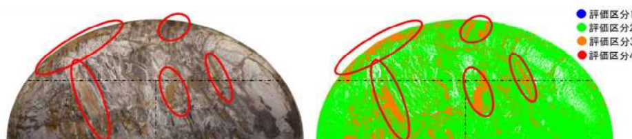
図-4 風化度自動評価結果の例
