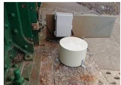
図-1 水晶加速度計の設置例
