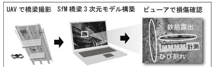
図-1 橋梁3次元データを活用する橋梁点検手法
