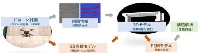
図-1 インフラ点検評価システムの概要
