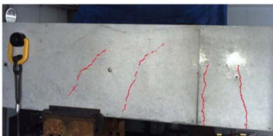
図-5 ひび割れの検出の一例
