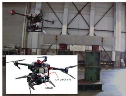
図-2 ドローン計測時の状況と計測装置
