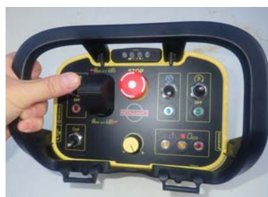
写真-4 遠隔操作リモコン
