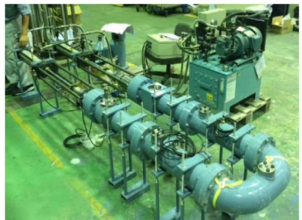
写真-1 ポンプ圧送性試験装置 1)
