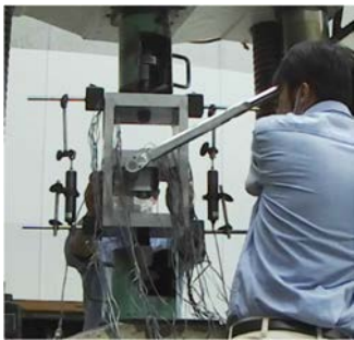
図 2 締結力導入試験状況
