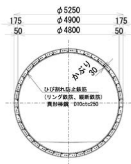
図-1 トンネル断面図
