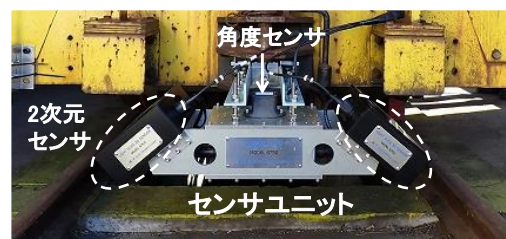
図1 動的軌間・平面性測定装置のセンサユニット
