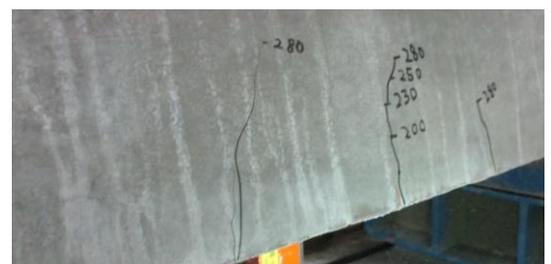
図-3 終局直前のひび割れの閉口
