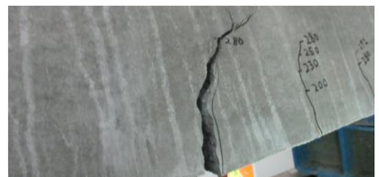
図-4 終局時のひび割れの開口
