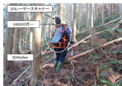
図 1 3D レーザーによる測定状況
