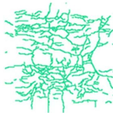
図-3 トンネル覆工のひび割れ(1)
