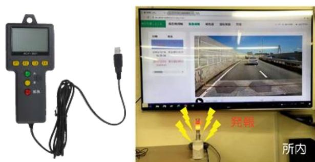
図-4 緊急ボタン及び緊急通報状況
