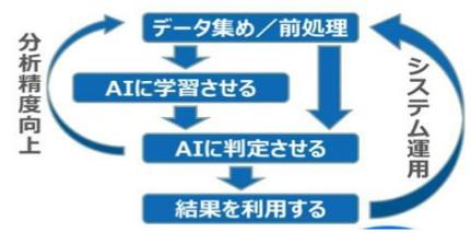
図3 市道維持管理システム運用と精度向上フロー
