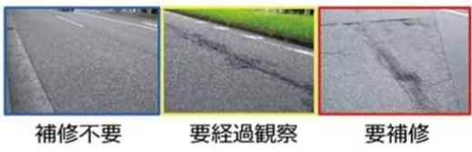
写真7 路面性状診断出力の例
