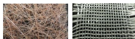
図3 補強材の外観 (左: 従来品, 右: 代替品)
