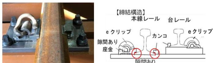
図1 基本締結構造（縦抵抗力無し）
