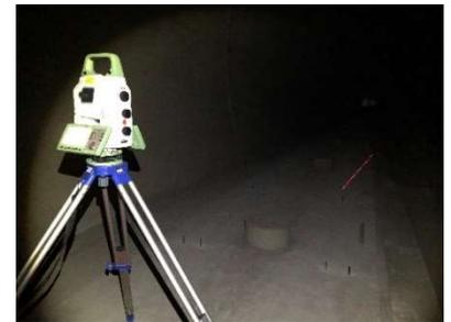
図-3 Leica 製マルチステーション
