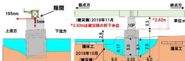
図-1 橋脚周辺の被災状況
