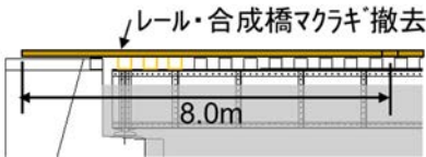
図-3 軌道仮撤去
